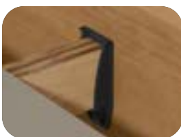
Dispositivo antirruído nos travessões
